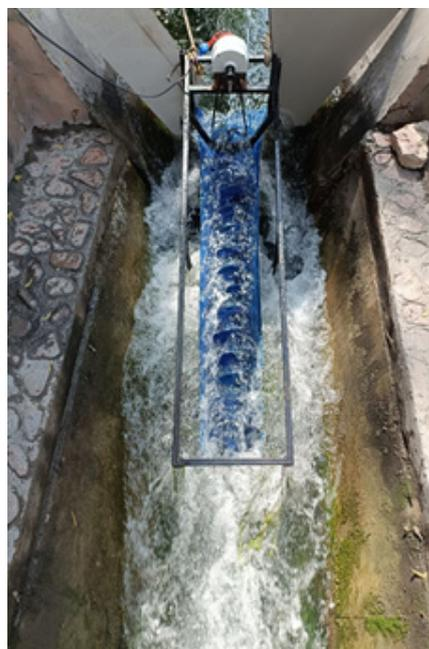
Рис.3. Процесс проведения экспериментальных исследований комбинированного энергетического устройства.
