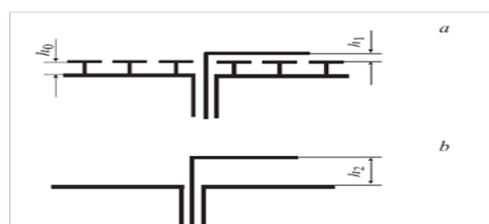
**Рис. 2.** Горизонтальный вибратор над высокоимпедансной поверхностью (а) и над металлической поверхностью с высокой проводимостью (b)
