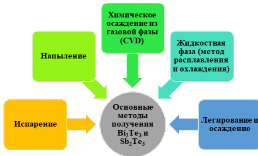
Рис. 1. Основные методы получения  $\text{Bi}_2\text{Te}_3$  и  $\text{Sb}_2\text{Te}_3$
