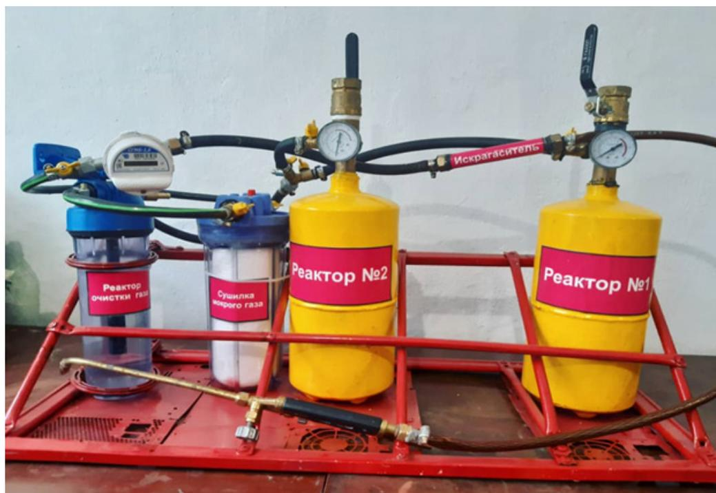
**Рис.1.** Установка генерации водорода
