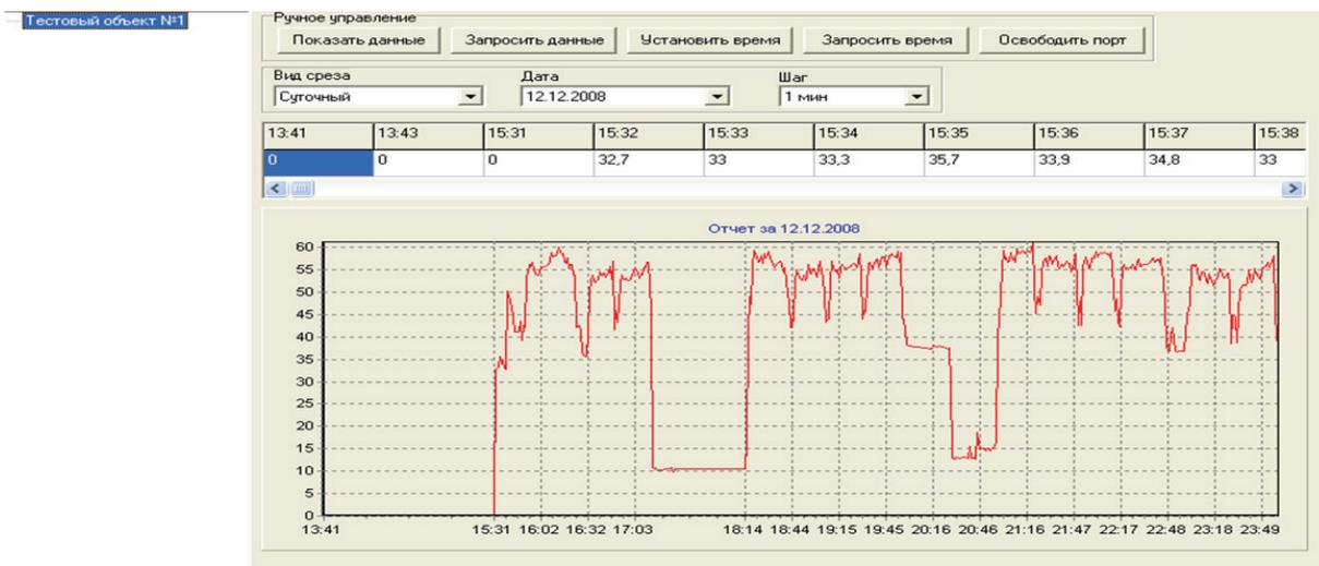
Рис. 1. Диаграмма потребления электрической энергии бурового станка
