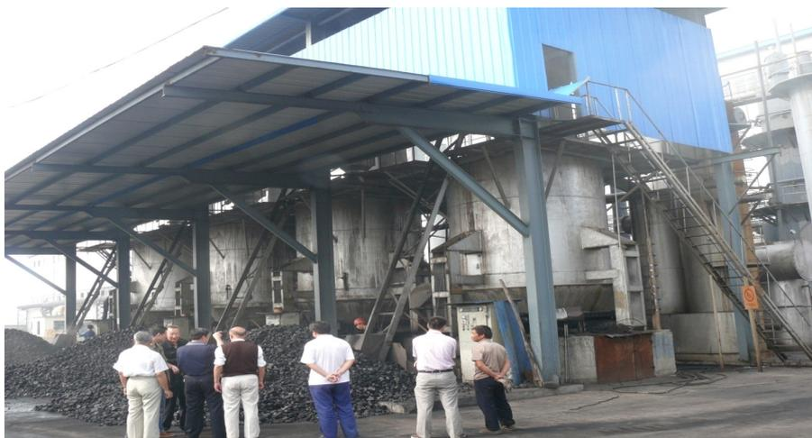
Рис. 3. Газогенераторы модели TYL-98, 0-3, 0 в работе
