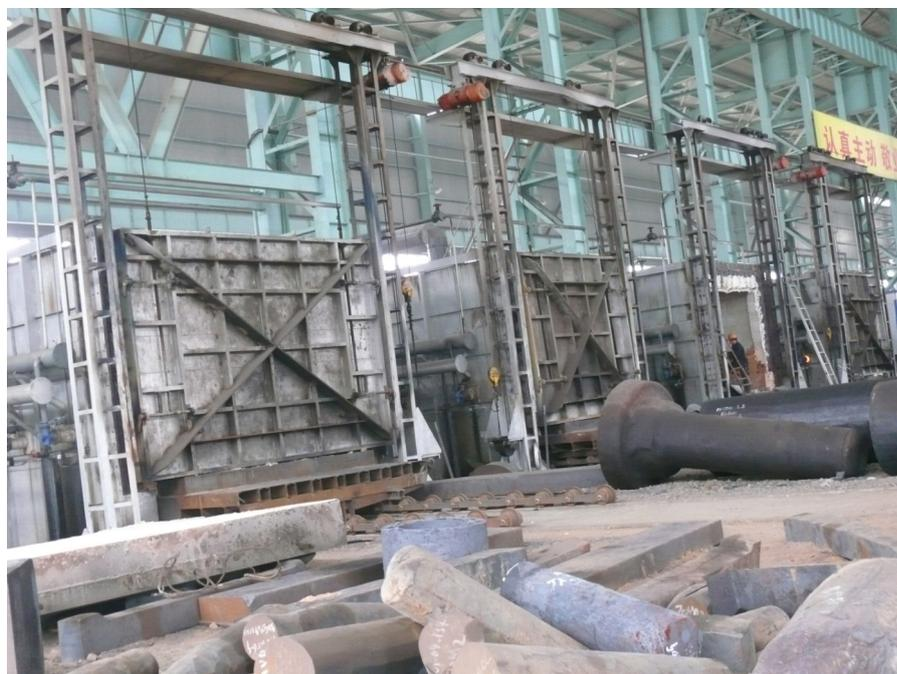
Рис. 4. Камерные печи для закаливания чугунных заготовок
