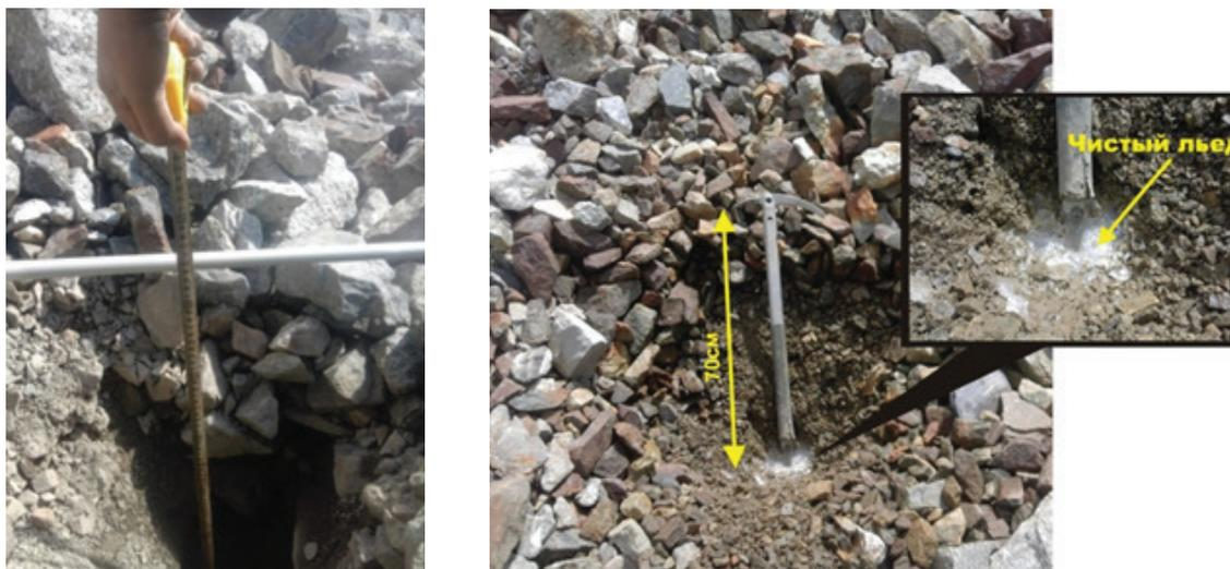
Рис. 3. Измерение толщины моренного чехла на забронированном участке ледника и искусственное обнажение льда. В точке измерения толщина моренного чехла составляет 70 см.
