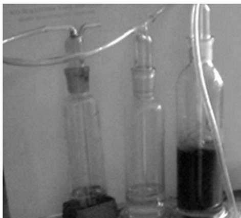
Рис. 1. Отгонка барботацией воздухом свободного цианида в уловитель с щёлочью
