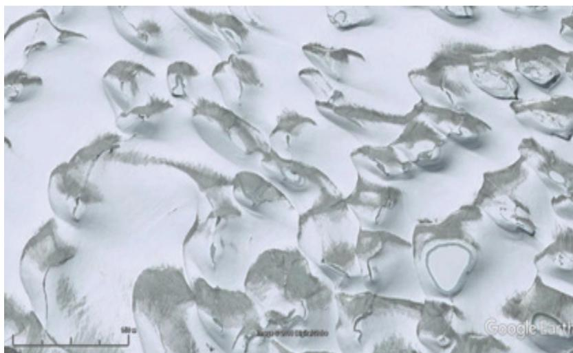
Рис.2. Сейсмообвалы в леднике на южном склоне хребта Акшийрак (южнее пика 4946 м на меридиане карьера «Кумтор»)
