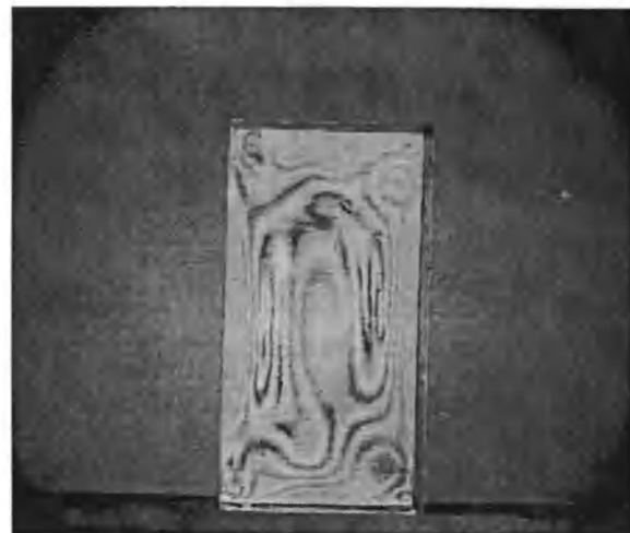
Рис. 4. Образец №9 с несимметричным – плоскополяризованным остаточным напряжением (параллельная к плоскости поляризации сторона – АВ).
