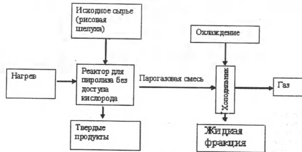
Технологическая схема пиролитиза рисовой шелухи.
