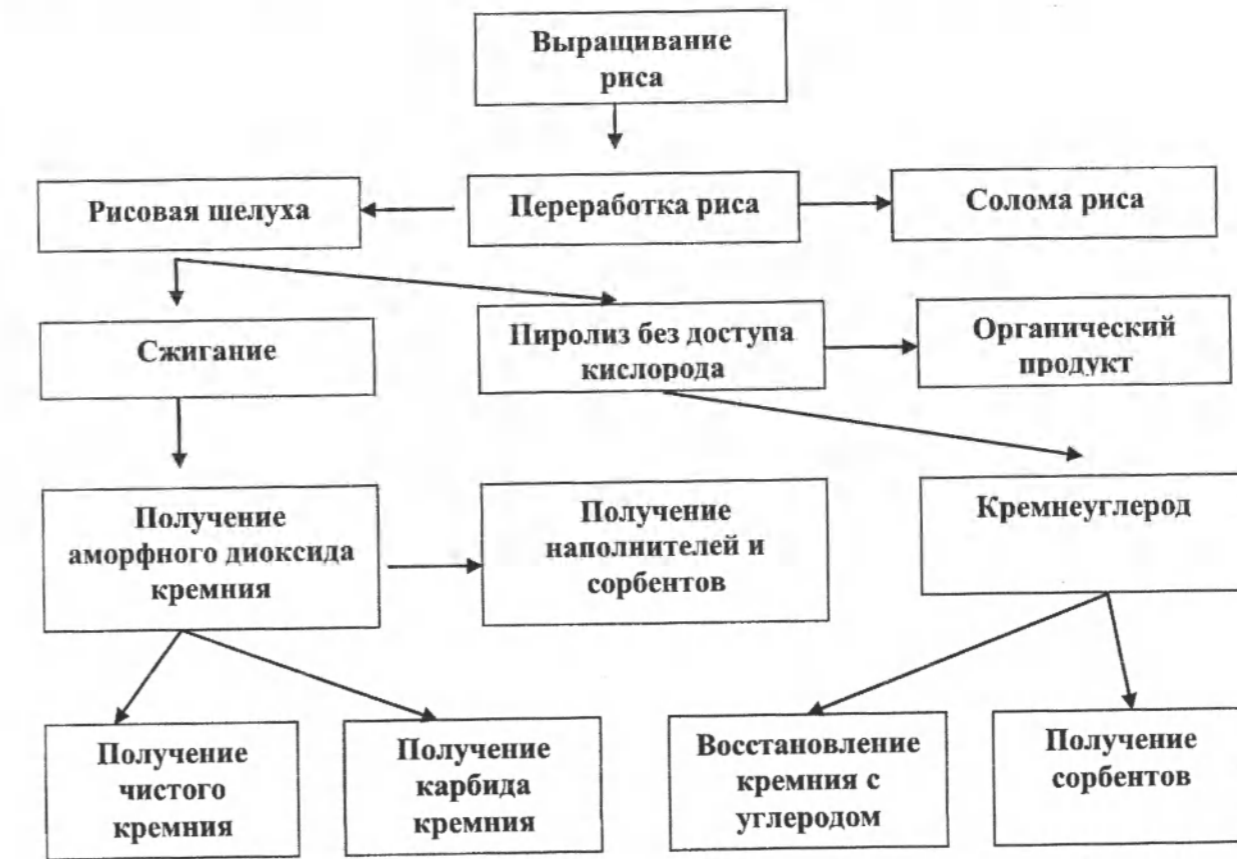
Схема переработки рисовой шелухи
