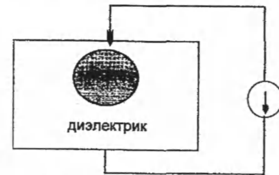
Металлическая пластина в диэлектрике (квантовая точка).
