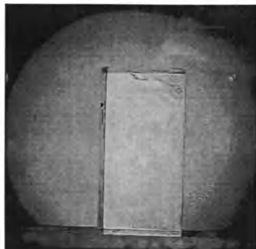
Рис. 5. Образец №9 с несимметричным – плоскополяризованным остаточным напряжением (перпендикулярная к плоскости поляризации сторона – ВС).
