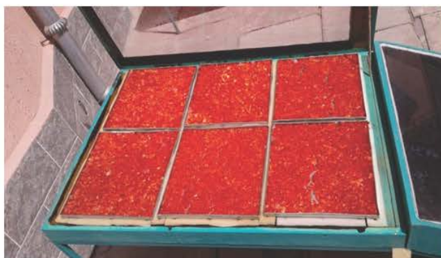
Рис.1 Размещение поддонов с продуктами (томаты) в камере сушки ССУ с двухходовым движением теплоносителя
