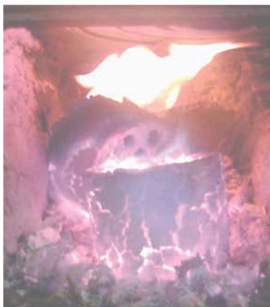
Рис. 3. Горение ФУБ с активированной бентонитовой глиной
