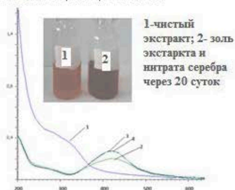
Рис. 1. УФ-спектры наночастиц серебра, полученных в экстрактах топинамбура «Интерес» после мацерации: 1 – чистый экстракт топинамбура (ЭТ); 2 – соотношение ЭТ:НС (2:98) через сутки; 3 – через 10 суток; 4 – через 20 суток
