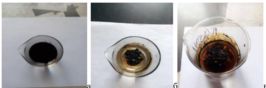
Рисунок 1. Результаты визуальной оценки эффективности сорбентов: а) нефть с водой, б) модифицированная форма сорбента с нефтью, в) нативная форма сорбента с нефтью.
